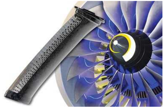
그림 8. Greene Tweed는 이중 성형 금속 선단부와 연간 1만 개 생산이 가능한 고속 공정을 사용하여 TPC 베인을 개발했다. 출처 | Greene Tweed
