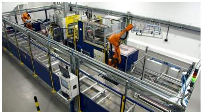
그림 9. Syensqo의 엔드투엔드 이중 다이어프램 성형(DDF) 시스템. 출처 | Syensqo
