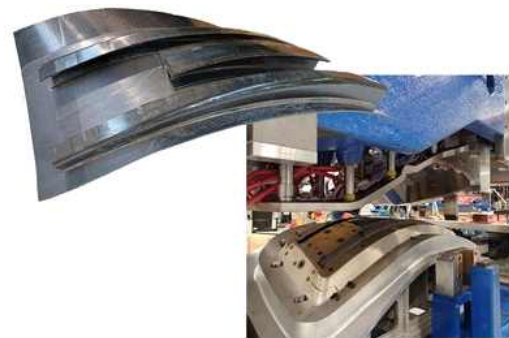
그림 6. SAUBER 4.0 프로젝트에서 RTM을 사용하여 제작된 복잡한 복합재 날개 끝 구조. 출처 | Airbus, SAUBER 4.0 프로젝트
