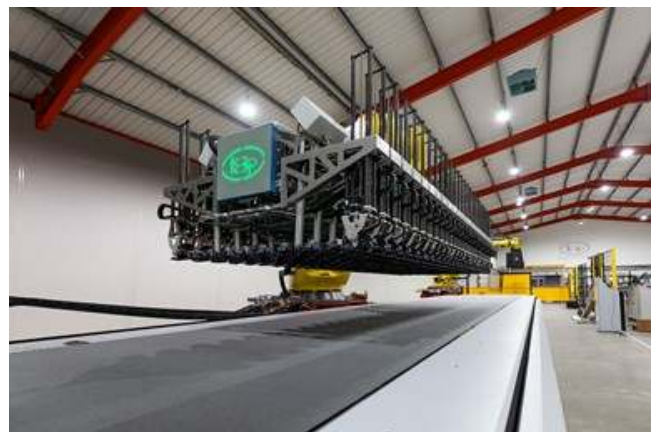
그림 11.고속 예비 성형을 위한 파이버라인 시스템. 출처 | Loop Technology
