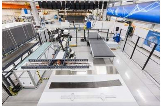
그림 10. 자동 적층 배치(APP) 기술. 출처 | Airborne
