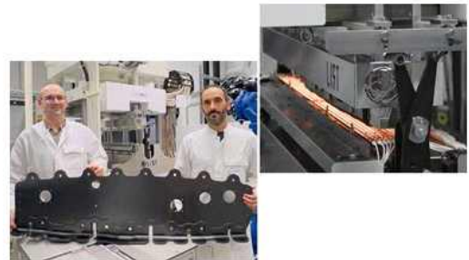
그림 7. 고하중 열가소성 날개 리브 시연기. 고하중 열가소성 날개 리브 시연 장치. 출처 | 룩셈부르크 과학기술연구소 (LIST)
