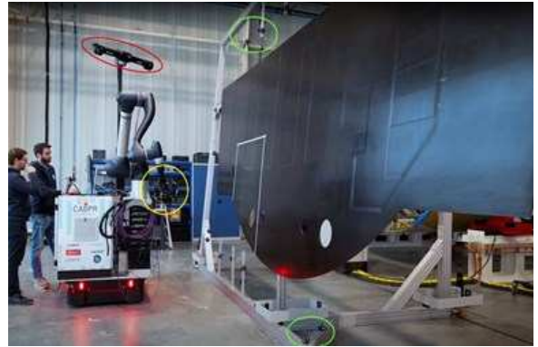
그림 18. FANTOM 프로젝트의 로봇이 Airbus 복합재 스파를 스캔하고 있다. 출처 | IRT 질 베른, FANTOM 프로젝트
