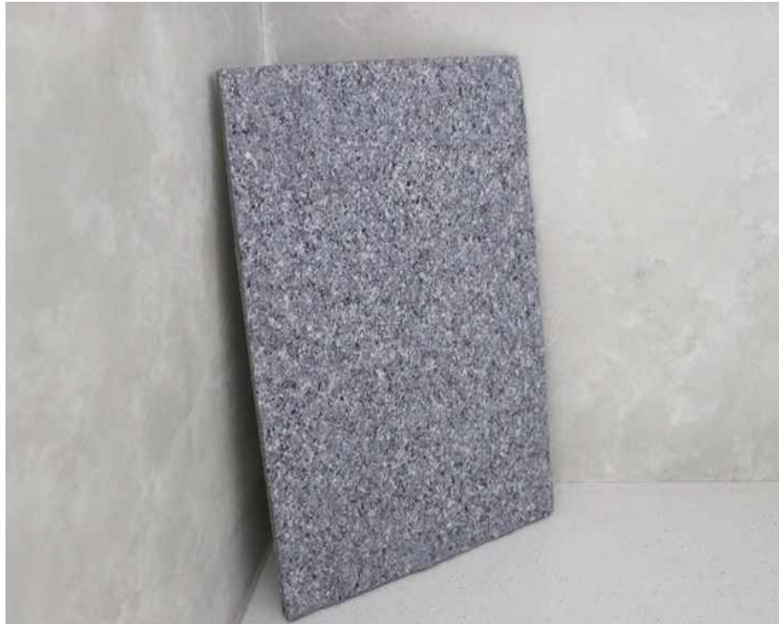
그림 6. 풍력 터빈 탄소섬유 프리프레그 폐기물 재활용 건축자재, 에코스톤. 출처 | Swancor Regener
