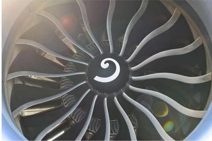
그림 9. 렌즈 플레어가 있는 GE9X 엔진. Boeing 777X 상업용 제트기에 동력을 공급할 GE9X 엔진은 지금까지 GE가 고분자 복합재 팬 블레이드와 케이스를 사용하는 가장 진보된 설계를 대표한다. 출처 | GE Aerospace
