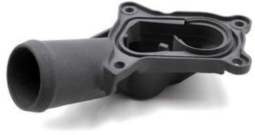
그림 15. "Celanese사의 PPS GF 40(포트론 1140L4) 소재로 제작된 세플러의 냉각수 매니폴드. 펠릿 3D 프린팅(Pellet 3D printing) 방식을 통해 제조되었음. 출처 | Schaeffler
