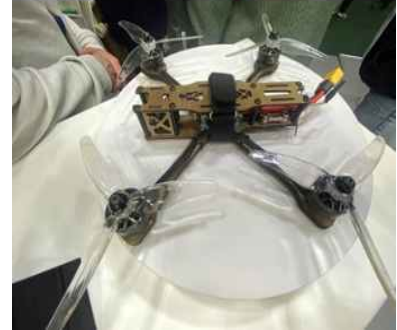
그림 10. Freshape는 JEC World에서 자사의 목재 섬유 기반 복합소재의 다양한 신소재 등급과 스포츠 용품부터 드론 본체에 이르기까지 적용 사례를 선보였다. 출처 | Freshape(상단), CW (하단)
