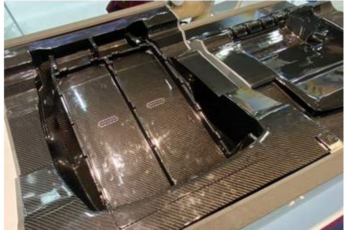
그림 22. Cannon 사의 Nexus 복합재 금형은 기존의 툴링 방식과 비교했을 때, 무게와 열적 관성, 그리고 에너지 사용량을 60~70%까지 절감. 출처 | Cannon
