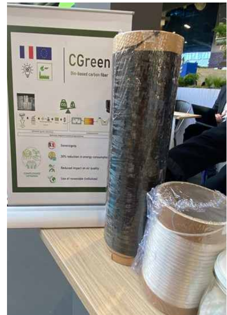
그림 9. CGreen은 나노셀룰로오스 전구체를 이용해 제조한 탄소섬유를 개발하고 있다. 출처 | CW
