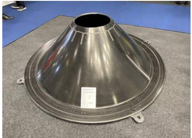
그림 23. 이 항공우주용 복합재 적층 금형(Lamination tool)은 폴리카보네이트(PC)와 20%의 탄소섬유가 함유된 소재를 활용하여 로봇 LFAM(대형 적층 제조) 방식으로 제작. 출처 | Caracol
