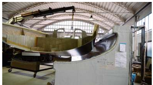
그림 13. NLCOMP 소재를 사용한 해양 제조 출처 | Marine Futures
