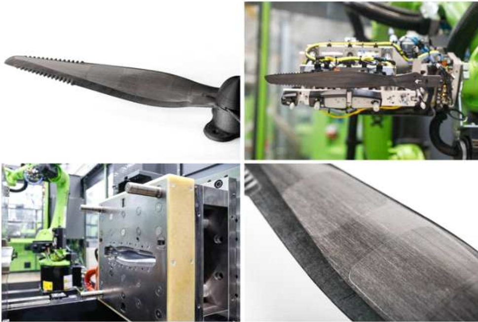
그림 12. ENGEL의 열가소성 복합재 드론 프로펠러 블레이드 자동화 공정. 출처 | ENGEL
