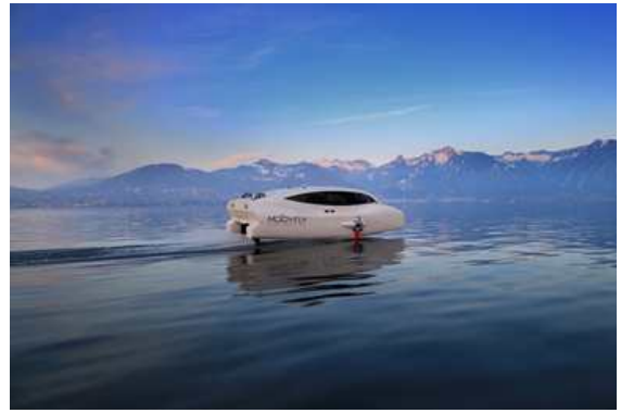
그림 14. MobyFly 무공해 수중익선. 출처 | Marine Futures
