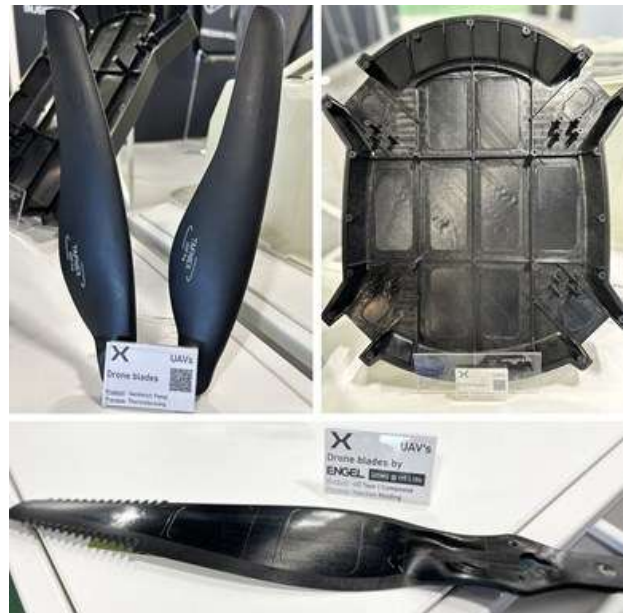
그림 12. 프로펠러 날개는 열성형 폼 코어 샌드위치 구조(왼쪽 상단)와 사출 성형으로 제작되었으며, 본체 구조 또한 TAFNEX를 사용하여 사출 성형되었다. 출처 | CW
