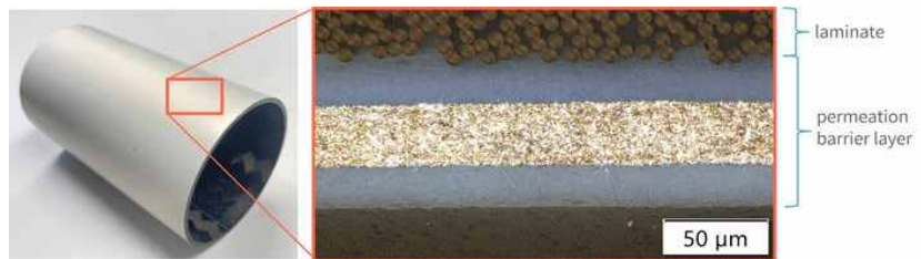
그림 2. CF/LMPAEK 튜브 벽의 단면 현미경 사진은 접착 계면 없이 적층판 층 사이에 금속 투과 방지층이 압축 성형 과정에서 열적으로 융합되었음을 보여준다.
