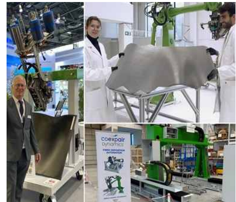
그림 6. Coexpair Dynamics는 프리프레그 또는 건조 섬유용 AFP(상단)와 RTM 또는 SQRTM 시스템(중앙)을 결합한 완전 생산 라인, 그리고 TPC 구조용 현장 압연을 사용하는 AFP 시스템(오른쪽 하단)을 포함한 새로운 자동화 솔루션을 개발하고 있다. 출처 | Coexpair Dynamics
