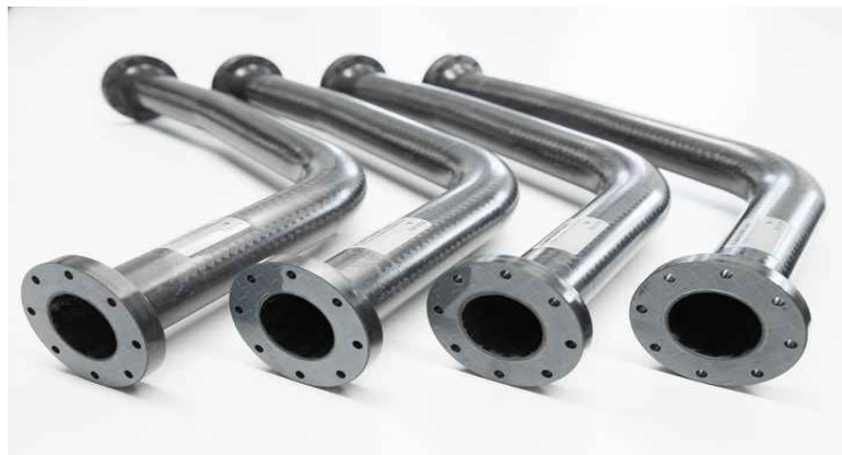
그림 3. CF/LMPAEK 일체형 플랜지는 튜브 본체와 연속적인 열가소성 소재 시스템을 형성하여 기존 극저온 라인 조립에 필요한 금속 부품 및 접착제 인터페이스를 제거한다. (모든 이미지 출처 | Herone GmbH)
