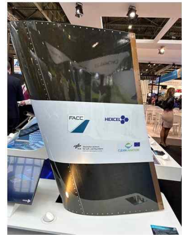
그림 8. 주입 및 기타 공정을 사용하여 제작된 멀티스파 플레퍼론 데모 장치가 JEC에서 전시되었다. Hexcel사가 전시한 멀티스파 플레퍼론 데모 장치. 출처 | CW
