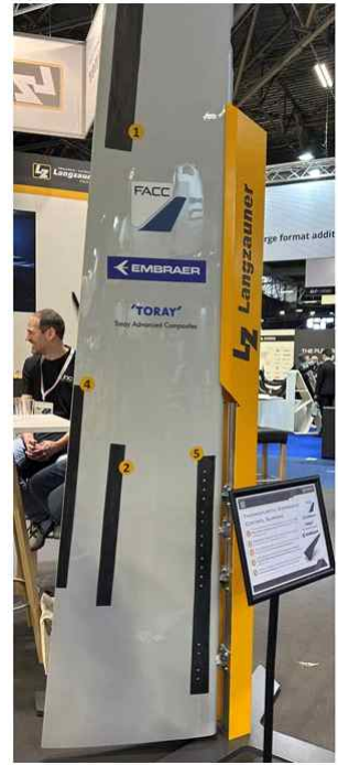
그림 7. JEC에서 전시된 열가소성 복합재 멀티스파 윙 가동 시연기. Langzauner 사에서 전시한 열가소성 복합재 멀티스파 날개 가동 구조 시연기. 출처 | CW
