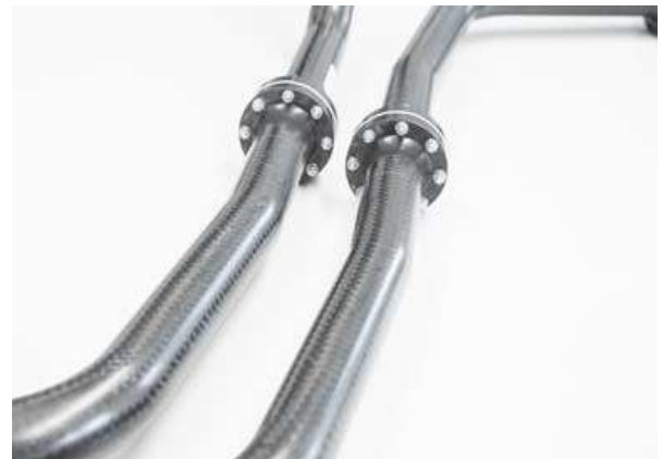
그림 1. 일체형 CF/LMPAEK 플랜지는 단일 프레스 공정에서 튜브 본체와 함께 성형되어 접합부 수와 시스템 질량을 줄이는 동시에 어셈블리 전체에 걸쳐 균일한 열가소성 재료 시스템을 유지한다. 출처 | Herone GmbH
