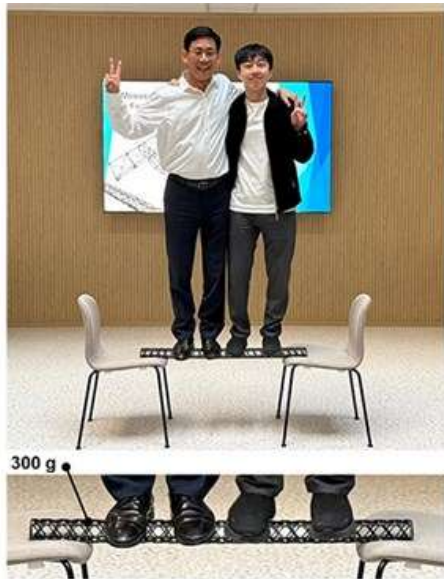
그림 16. 서울대학교 기계공학과 안성훈 교수와 최준영 박사가 본 연구에서 개발한, 총 약 150kg의 하중을 지탱할 수 있는 300g 무게의 복합 빔 위에 서 있다(왼쪽). 오른쪽에는 연구팀이 개발한 시제품 구조물(드론, 로봇 팔)이 있다. 출처 | 서울대학교
