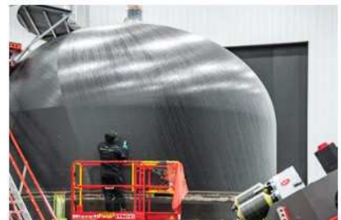
그림 2. AFP 1단계 탱크 부품 생산. 출처 | Rocket Lab
