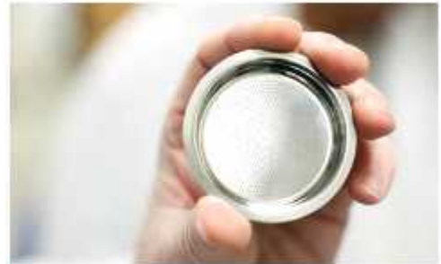
그림 7. ORNL에서 습식 방사 방식으로 3엽형 PAN 필라멘트를 생산하기 위해 맞춤 설계한 방사구. 출처 | ORNL
