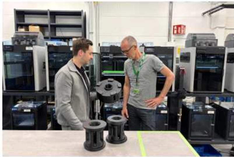
그림 10. Neuenhauser Maschinenfabrik의 프린트 팜. Luvocom3F 프린터로 출력한 기계 부품들. 출처 | Lehjvoss
