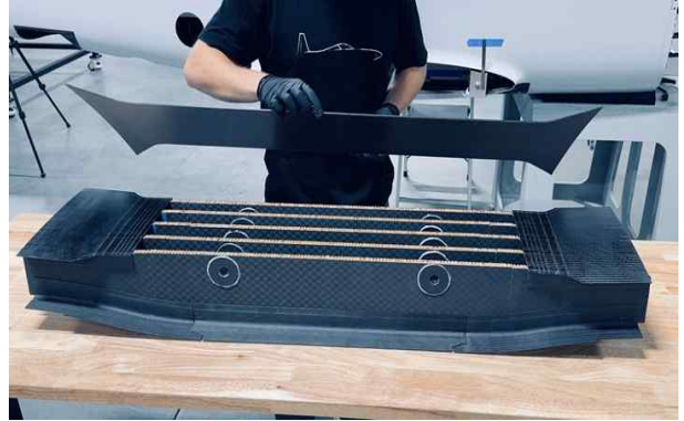
그림 20. 수정된 DarkAero 1 중앙 날개 박스 구조의 가조립은 날개 구조 외부에서 수행할 수 있다. 하부 날개 표면의 곡률은 하부 파이 조인트 끝 부분에서 확인할 수 있다. 출처 | DarkAero
