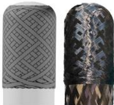
그림 13. 필라멘트 와인딩 돔 보강층의 제조 과정 시연. 출처 | RWTH 아헨 대학교 ITA
