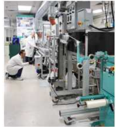
그림 5. ORNL 연구원들(사진 뒤쪽은 밥 노리스, 앞쪽은 푸에시웅)이 실험실 규모의 습식 방사 라인을 사용하여 탄소섬유 제조에 필요한 PAN 토우를 생산하고 있다. 출처 | ORNL
