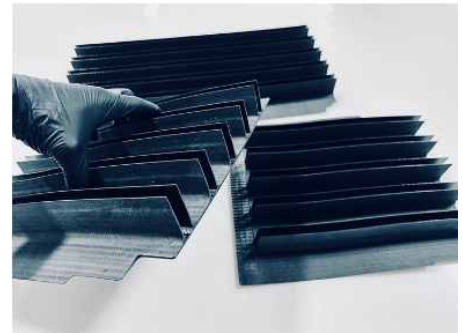
그림 19. 중앙 날개에 설치하기 전의 다중 파이 접합 구조물이다. 이 주요 구조 요소는 오토클레이브 처리 없이 상온에서 보관한 프리프레그를 사용하여 제작되었다. 중앙 날개 부분의 물리적 공간 제약으로 인해 적절한 설치를 위해 세 부분으로 나누어 제작해야 했다. 출처 | DarkAero
