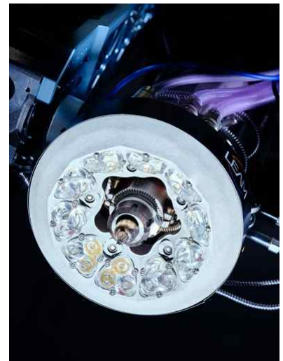
그림 5. 아래에서 본 프린트 헤드는 중앙 노즐을 중심으로 동심원 형태로 배열된 집속형 LED 이미터와 개별 렌즈 어셈블리를 보여주며, 이들은 함께 적층 계면에서 국부적인 용융 풀을 생성한다. 출처 | LEAM Technologies
