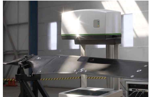
그림 26. Adaptix의 비파괴 검사(NDT) 기술이 복합소재 헬리콥터 프로펠러 블레이드에 적용된 모습이다. 출처 | Adaptix Ltd.
