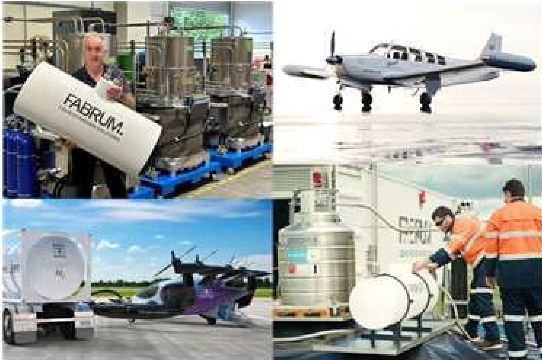
그림 24. Fabrum은 무공해 항공 분야를 위한 경량 복합소재 액체 수소(LH 2 ) 탱크를 개발했으며, 5와트 미만의 열 손실로 빠른 충전이 가능하다는 것을 입증했다. 출처 | Fabrum
