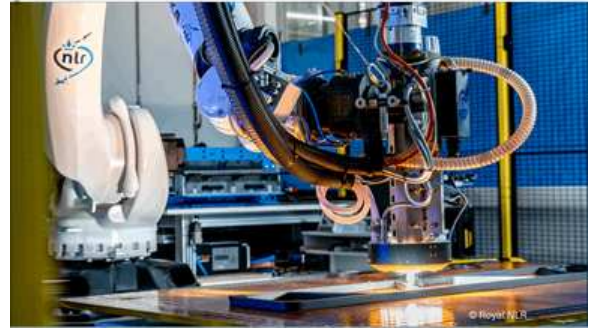
그림 8. 네덜란드 항공우주센터(NLR)의 DEMEX 시스템은 열가소성 소재를 출력하고 있으며, 출력 영역에서 LEAM Technologies LED의 발열 빛이 보인다. 출처 | NLR
