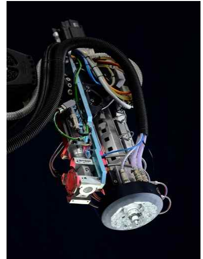
그림 6. LED 이미터 링은 압출 메커니즘 바로 아래에 장착되어 기존 장비 구조에 큰 부피를 추가하지 않고도 열 제어 하드웨어를 프린트 헤드에 통합한다. 출처 | LEAM Technologies
