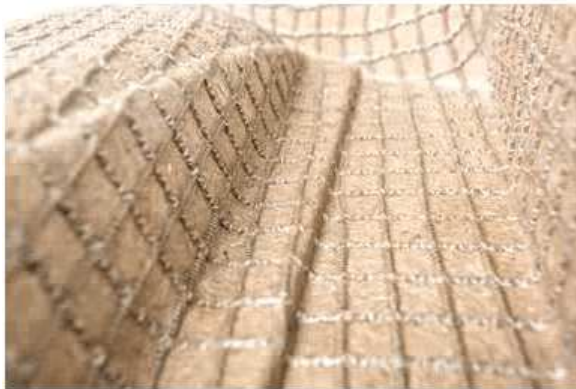
그림 18. Bcomp의 ampliTex와 powerRibs는 자동차 내부 패널에 적용되었다. 출처 | Bcomp
