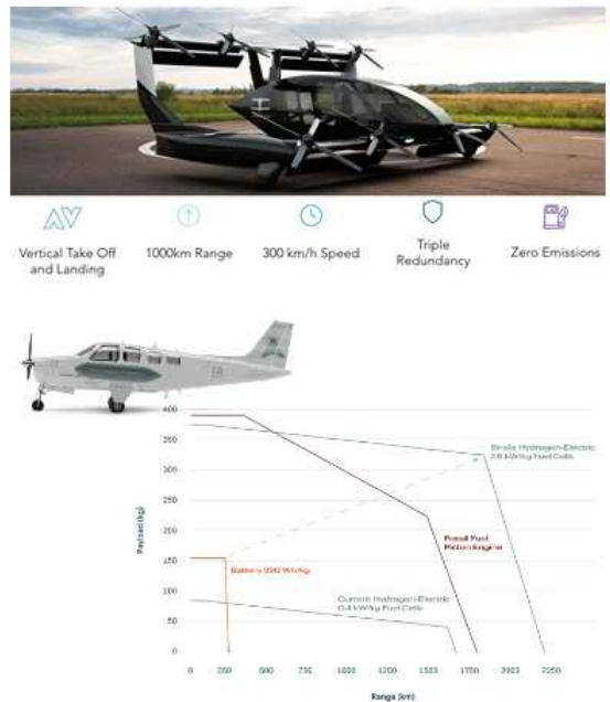
그림 23. AMSL Aero의 Vertiia eVTOL(위)과 Stralis Aircraft의 일반 항공기용 연료 전지 추진 개조 시스템(아래)은 LH 2 와 Fabrum의 복합재 탱크를 사용하여 배출가스 제로 비행으로 훨씬 더 긴 항속 거리 제공. 출처 | AMSL Aero, Stralis Aircraft
