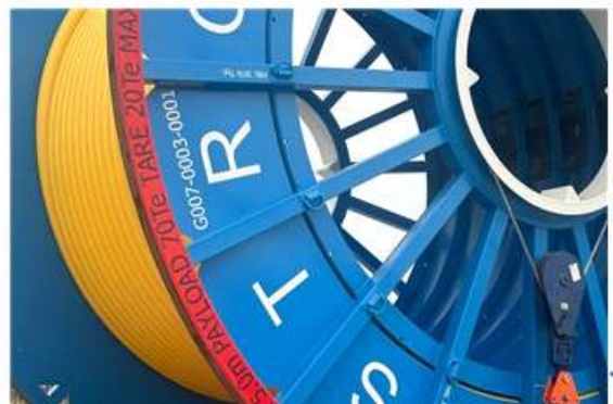
그림 28. Strohm의 TCP 유동관은 가스 생산에 사용될 예정. 출처 | Strohm
