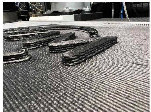
그림 7. 오버프린팅 테스트 중 이전에 인쇄된 표면에 열가소성 수지를 직접 증착한 모습. 출처 | LEAM Technologies
