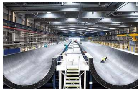
그림 2. 덴마크 Vestas 나크스코브 블레이드 공장의 V236-15.0MW 블레이드 금형. 출처 | Vestas A/S
