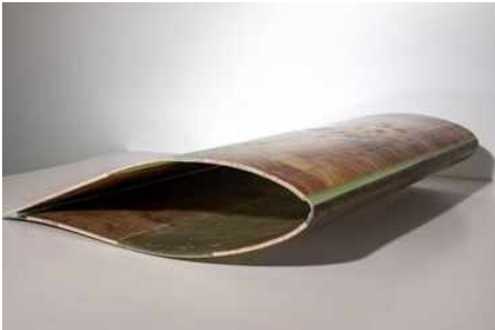
그림 9. REFRESH 컨소시엄의 진공 주입식 블레이드 끝단 프로토타입은 다른 풍력 터빈 블레이드에서 추출한 재활용 유리섬유(rGF) 매트를 일부 사용하여 제작되었다. 출처 | Gjenkraft AS
