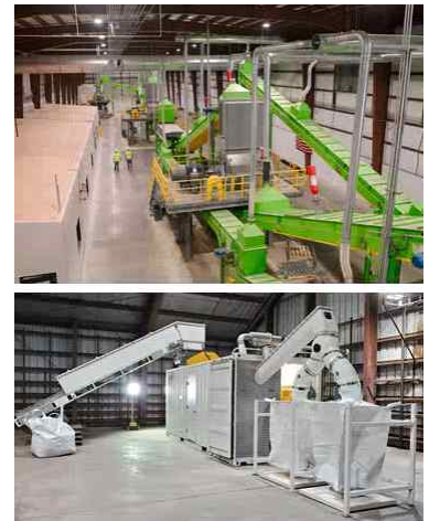
그림 7. 위쪽 이미지는 Regen Fiber의 아이오와 재활용 생산 라인을 보여줍니다. 아래쪽 이미지는 GRI에 설치된 (Isodan Engineering의 컨테이너형 재활용 공장을 보여줍니다. 출처 | Regen Fiber (위), Isodan Engineering (아래)
