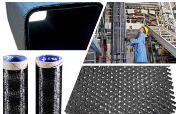
그림 18. GA-EMS의 CMC(화학, 제조 및 가공) 작업은 원자력 기술 구현을 위해 다양한 형태로 이루어지며, 여기에는 이 유동 채널 삽입 프로토타입(왼쪽 상단)과 같은 SiC/SiC 부품, 최대 12피트 길이의 SiGA 연료 피복재(오른쪽 상단), 자동 광섬유 배치로 제작된 SiC 프리폼(오른쪽 하단) 및 SiC 광섬유(왼쪽 하단)가 포함된다. 출처 | GA-EMS
