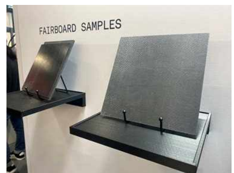
그림 12. 이 회사의 일반적인 단층 칩 기반 제품과는 달리, FairBoards는 압출 성형 프로파일로 만든 다층 패널이다. 사진 속 샘플은 JEC World 2026에서 전시되었다. 출처 | CW
