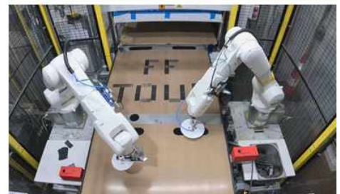
그림 11. FairPly소재(상단) 제조 구역 (FairFactory 투어 중 중간 이미지 참조)은 FairTrack을 통해 정밀한 적층을 위해 최적화된 픽애플레이스 로봇 셀(하단)로 구성된다. 출처 | Fairmat
