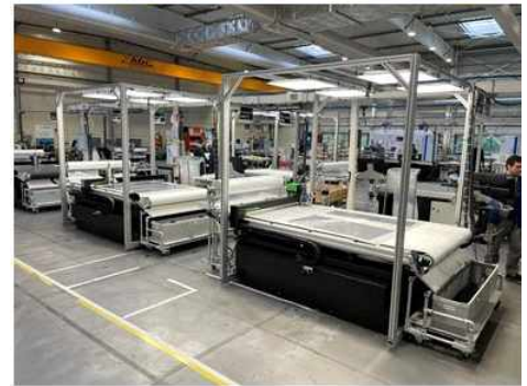
그림 9. Fairmat의 칩 생산을 위한 주요 공정 단계는 유사한 폐자재를 적층 및 경화시켜 단층 라미네이트(상단)를 만든 다음, 이를 칩이나 시트로 절단하여 다른 재료 제품을 만드는 데 사용하는 것이다(하단). 출처 | Fairmat
