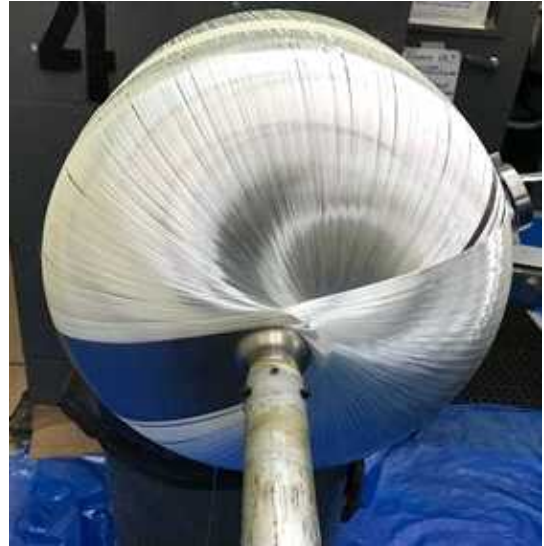
그림 28. 복합재 외피 압력 용기(COPV). 출처 Apex Space & Defense Systems
