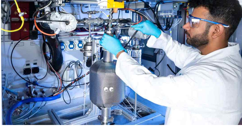
그림 12. Fraunhofer ISE의 직접 공기 포집 시험 장치. 출처 | Fraunhofer 연구소
