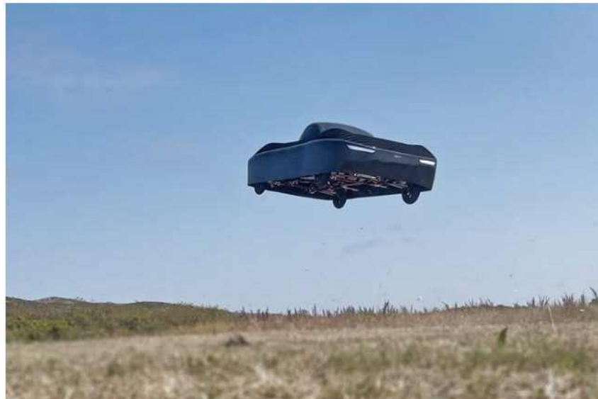
그림 1. 하늘을 나는 자동차 시험. Alef 실물 크기 자동차의 저고도 비행 시험. 출처 | Alef Aeronautics
