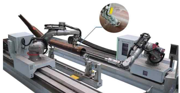
그림 17. 헬리콥터 테일붐 자동 검사에 사용되는 산업용 LEA 기반 검사 시스템. 삽입 그림: 투과형 검사 헤드의 레이저 기반 초음파 발생 장치. 출처 | Xarion Laser Acoustics
