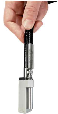
그림 18. 이 소형 광섬유 결합 검사 헤드는 협소하고 접근하기 어려운 영역에서 자동화된 단면 검사를 가능하게 한다(크기 비교를 위해 손을 함께 표시). 눈에 안전한 레이저를 사용하여 접촉 없이, 결합 젤 없이, 항공기 날개와 같은 내부 재료 결함의 초음파 이미지를 생성한다. 출처 | Xarion Laser Acoustics
