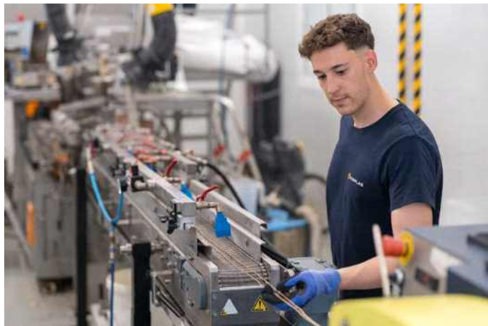
그림 12. 이 사진은 PA66으로 만들어진 통기성 직물(진공 포장 백의 통기성 층) 충전재의 배합 공정을 보여준다. 이 소재는 분쇄, 압축 과정을 거쳐 30%의 유리 섬유와 혼합되어 펠릿 형태의 재활용 소재로 만들어진다. 출처 | Aimplas
