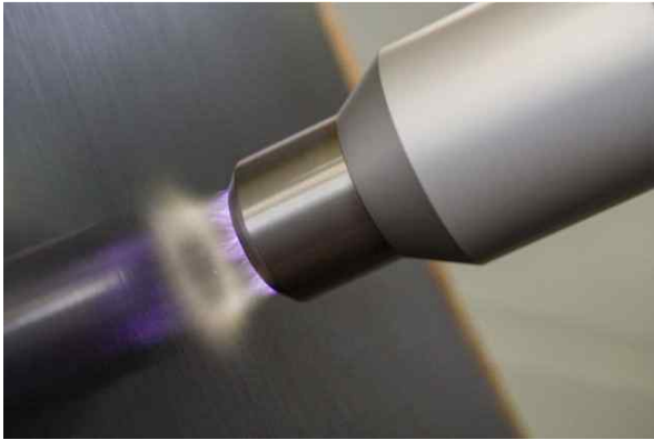
그림 10. 탄소섬유강화플라즈마(CFRP) 표면의 비접촉식 대기압 플라즈마 전처리. 출처 | Fraunhofer IFAM
