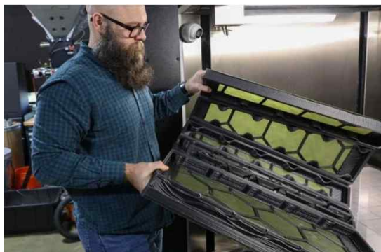
그림 17. ORNL의 스티븐 구조렉은 연구소의 하이브리드 3D 프린팅 방식을 시연하고 있다. 이 방식은 유연한 나일론 직물 위에 통합층과 복합 재료를 직접 적층하여 금형 없이 평평하게 접을 수 있는 구조물을 만들어 생산 비용을 절감하고 설계 유연성을 높인다. 출처 | 에이미 스모더만 버지스/ORNL, 미국 에너지부
