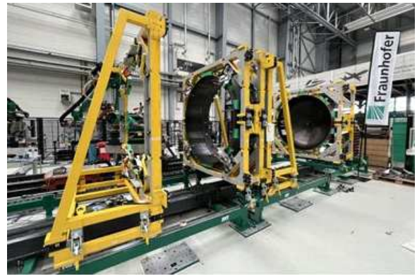
그림 11. 항공기 운용을 위한 경량 탄소섬유강화폴리머(CFRP) 수소 탱크의 양산 가능성을 향한 중요한 이정표 — 유연하고 모듈식이며 자동화된 조립 시스템. 출처 | FFT Produktionssysteme GmbH & Co. KG 및 Fraunhofer IFAM
