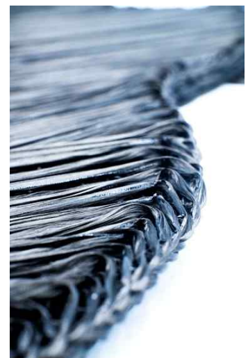
그림 22. 완성된 건식 섬유 프리폼은 금형 이송 전에 핀으로 지지된 형상을 유지하며, 절단되지 않은 섬유 다발은 부품 경계까지 연속적으로 연결되고 가장자리 재료가 잘려나가지 않는다.
