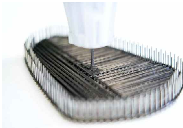
그림 27. Holy Technologies의 IFP 엔드 이펙터는 로봇 적층 과정에서 각 패스를 장력 하에 고정하고 최종 형상의 프리폼 경계를 정의하는 주변 금속 핀 주위에 연속적인 탄소섬유 토우를 감는다. 출처 | Holy Technologies
