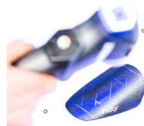
그림 23. 표면에서 가변축 섬유 구조가 보이는 IFP 방식으로 제작된 CFRP 부품으로, 후경화 가공이 필요 없는 폐쇄형 금형 넷트 셰이프에서 생산되었다.
