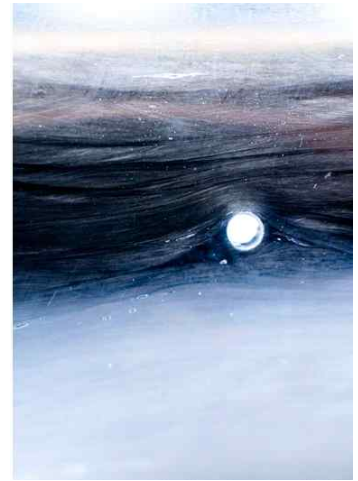
그림 26. 구조 부품 이미지는 통합된 하중 지지 구멍 주변으로 끊어짐 없이 연속적으로 배선된 IFP 섬유 다발을 보여주며, 부품에서 가장 응력이 높은 위치에서 섬유의 연속성을 유지한다.
