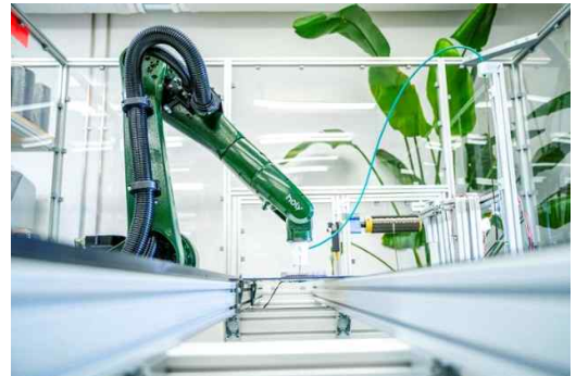
그림 24. Holy Technologies의 6축 KUKA 로봇은 IFP 엔드 이펙터를 장착하고 디지털 방식으로 사전 계산된 섬유 경로를 따라 생산 도구 표면을 가로지른다.
