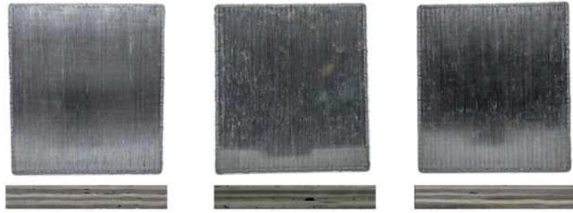
그림 25. 새것(왼쪽), 재활용(중앙), 그리고 재사용(오른쪽)된 Teijin 테낙스 섬유로 제작된 CFRP 시험판의 단면 현미경 사진은 재활용 단계를 거치면서 섬유 부피 분율(FVF)이 44%에서 35%로 감소하는 섬유 다발의 점진적인 확산을 보여준다.
