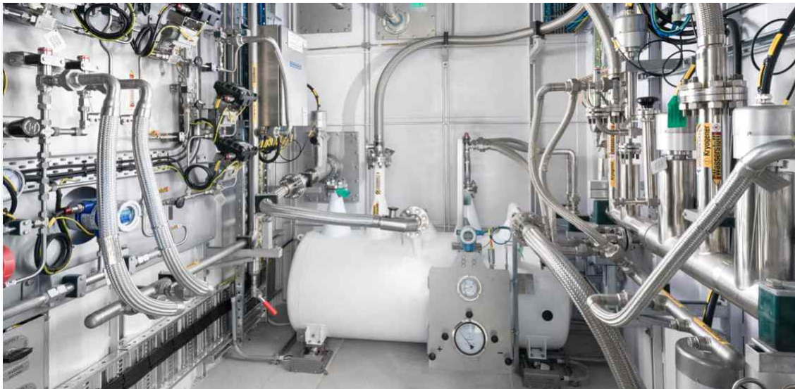
그림 34. 액화기는 수소 가스를 극저온까지 냉각. 출처 | KIT
