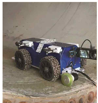
그림 10. 터빈 블레이드 내부를 검사하는 로버는 접근하기 어려운 터빈 영역을 원격으로 실시간 검사할 수 있도록 하여 안전성을 향상시킨다. 출처 | JEC Magazine
