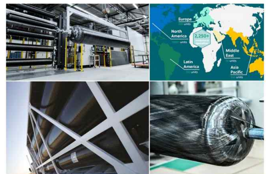
그림 20. Hexagon Composites의 Type IV 복합재 압력용기. 출처 | Hexagon Composites
