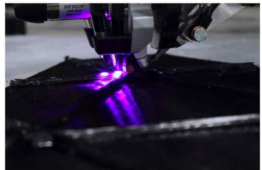
그림 3. 탄소섬유 복합재 3D 프린팅. 출처 | Continuous Composites Inc.
