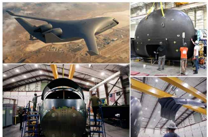
그림 28. JetZero의 Jet1 시연용 BWB 항공기 및 복합재 구조물. JetZero의 첫 번째 실물 크기 BWB 항공기인 Jet1 시제기가 Scaled Composites와의 협력을 통해 제작되었다. 사진에는 복합소재로 제작된 후방 압력 격벽(오른쪽 위)과 조종석(왼쪽 아래)이 포함되어 있다. 출처 | JetZero
