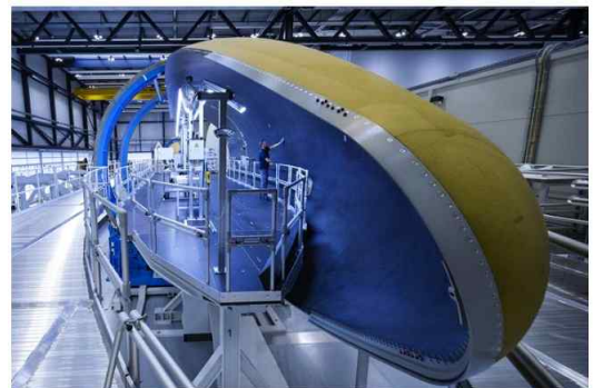
그림 18. Emmens 페이로드 페어링. Beyond Gravity의 복합재 탑재체 페어링은 알루미늄 허니콤 코어에 CFRP 복합재 커버 레이어를 적용하여 제작되었으며, 현재까지 400회의 로켓 발사에 사용됨.
